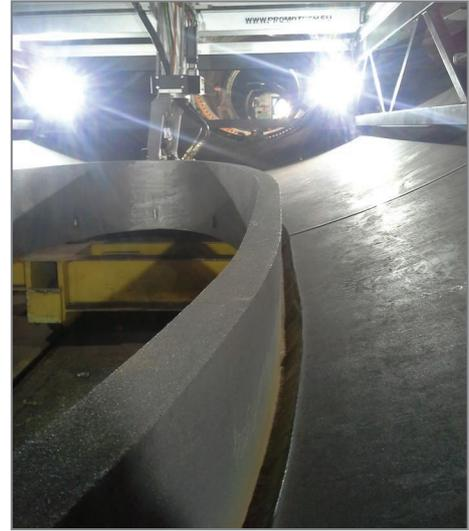
La machine MCM permet la découpe et le chanfreinage de surface multiples. Ceci permet une préparation idéale des pièces et le soudage sous flux de haute qualité.
