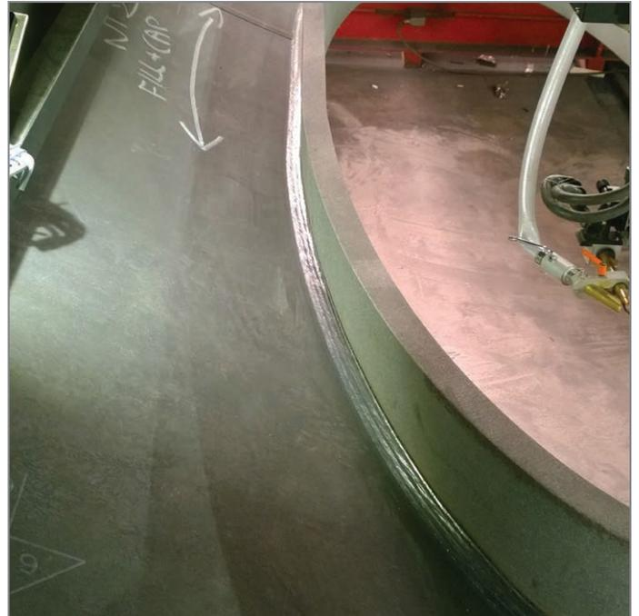
Le balayage, l'oxycoupage/chanfreinage et le soudage des portes d'accès / un seul opérateur.
