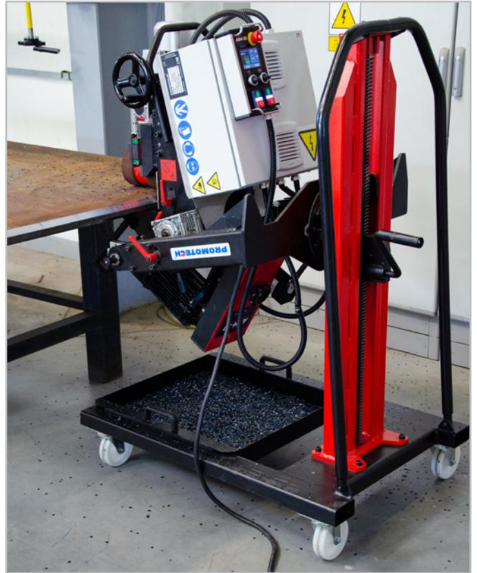
■ Les réglages précis de la vitesse de rotation et de la vitesse d'avance optimisent l'usinage de différents matériaux incluant l'acier, l'inox, l'aluminium etc.
