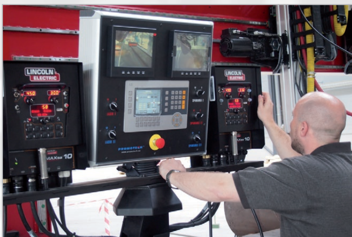
Demi portique de type WA pour le soudage de poutrelles et citernes avec équipement LINCOLN POWERWAVE AC/DC
