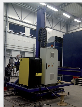
Demi portique de type WA pour le soudage de poutrelles et citernes avec équipement LINCOLN POWERWAVE AC/DC
