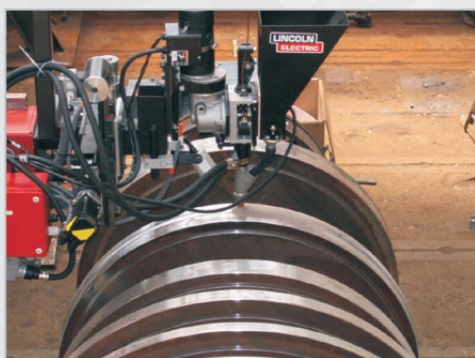
Rechargement de turbines
