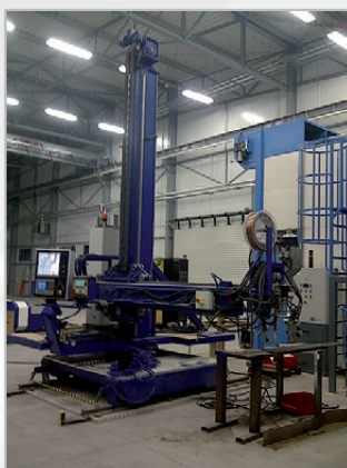
Potence standard avec équipement ESAB Aristo 1000 AC/DC
