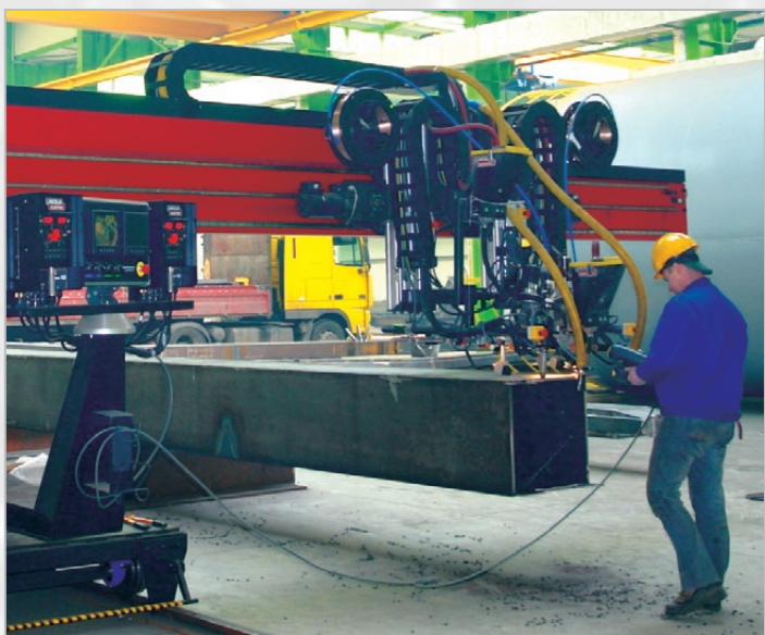
Potence standard avec équipement ESAB Aristo 1000 AC/DC
