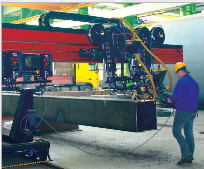
Potence standard avec équipement ESAB Aristo 1000 AC/DC
