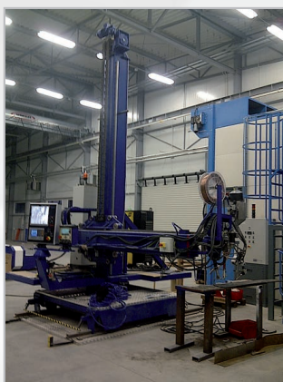
Potence standard avec équipement ESAB Aristo 1000 AC/DC
