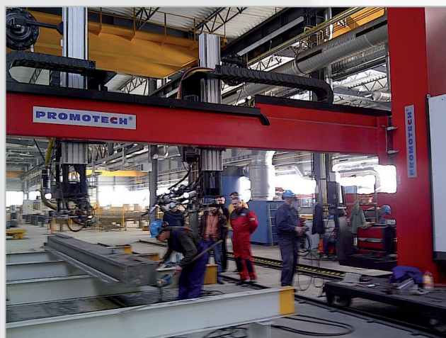
Demi portique de type WA pour le soudage de poutrelles et citernes avec équipement LINCOLN POWERWAVE AC/DC
