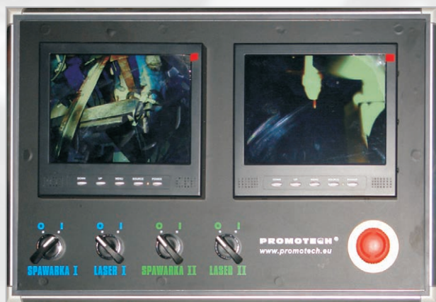
Accessoires optionnels : système écran/caméra, correction automatique de la position de la torche, commande à distance
