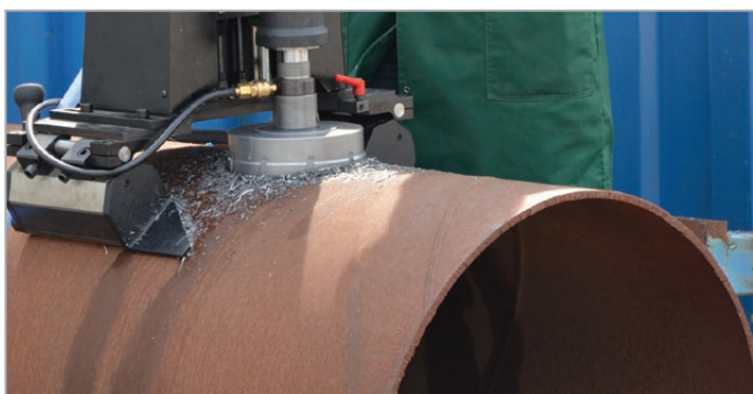
PRO-200A ATEX peut être fixé sur des tubes d'un diamètre minimum de 950 mm (37,4").
