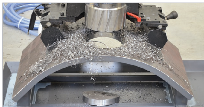
Base à aimants permanents adaptable à la courbure de la pièce à usiner
