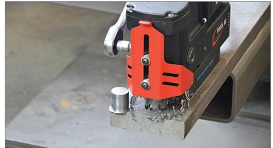
Capacité de carottage max. 36 mm
