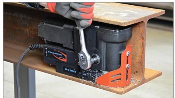
Ultra compacte permettant l'accès dans les endroits les plus serrés. Levier de descente amovible (clé à cliquet) adaptable des 2 côtés
