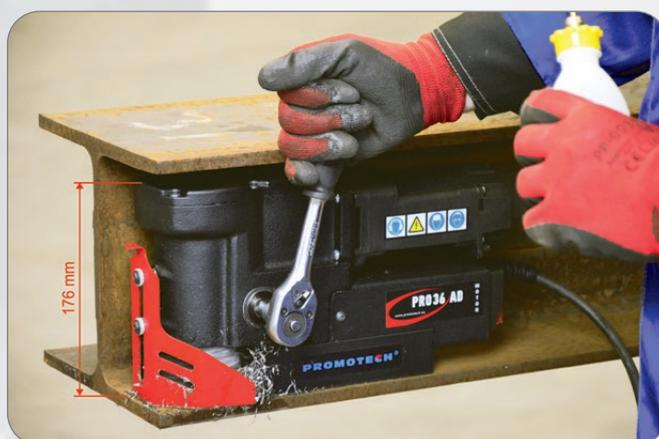
PRO-36 AD fonctionne dans les endroits les plus serrés
