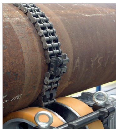
Chaîne ajustable (ø200-1000mm) assure la rotation axiale positive
