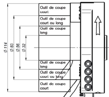
Le choix de l'utilisation des outils de chanfreinage standards ou longs simultanément avec l'outil de dressage 0° dépend du diamètre du tube
