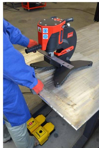
Commandes au pied pour un fonctionnement en configuration établi sans les mains.
