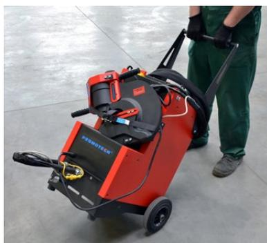
Centrale hydraulique mobile avec étagère pour la poinçonneuse.
